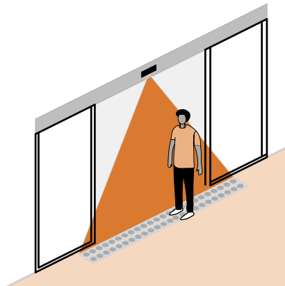
الشكل C.36 باب أوتوماتيكي يتم التحكم فيه بجهاز استشعار
