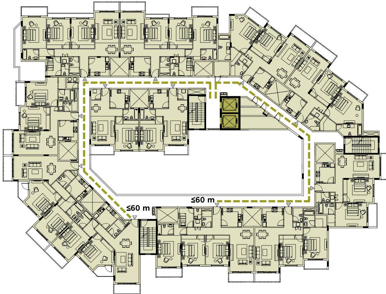
الشكل D.3 المخطط الأفقي لطابق بردهة مصاعد يوضح أقصى مسافة وصول للمصعد
